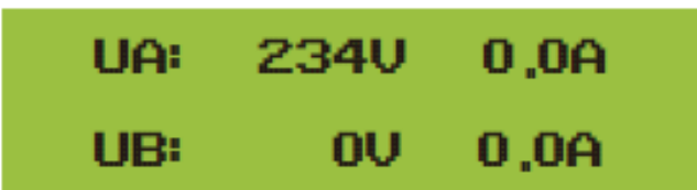
Kuva 8.1.4 Verkon jännite- ja virtatiedot.
