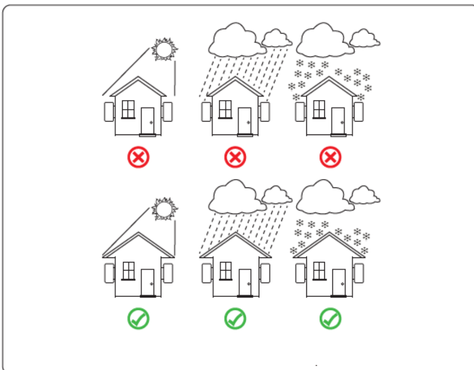
Kuva 4.1.1 Invertterin suositellut asennuspaikat rakennuksen julkisivulla.
