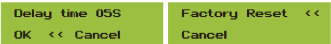
Kuva 8.3.4 Viiveajan asetus, sekä tehdasasetusten palautus.
