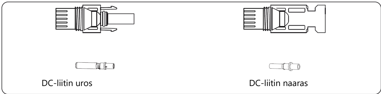
Kuva 5.2.4 Havainnekuva tasavirtapuolen uros- ja naaraspuolen liittimistä.
